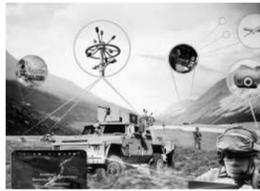
“回旋镖”射击检测系统,是国外一家公司为应对战场冷枪袭击而研制的预警系统。该系统通过对袭击者枪口发出的声音和冲击波进行探测,然后对接收到的信号进行记录、识别和数据处理,计算机将给出袭击者的具体方位。
